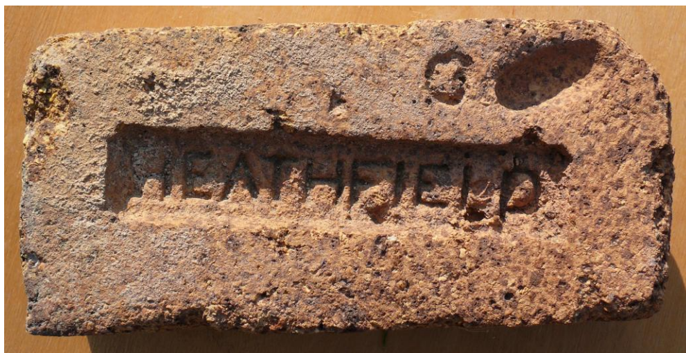
Фото 1. Кирпич с клеймом «HEATHFIELD» завода Heathfield Fireclay Works, Шотландия (дата изготовления – около 1880 г.). Применялся в строительстве доменных или коксовых печей Гданцевского чугунолитейного завода.
